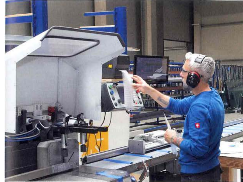
Nach dem Zuschnitt wird über einen Etikettendrucker für jedes Profil automatisch ein Einzeletikett gedruckt.
