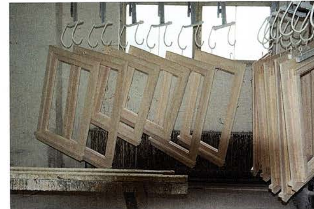
/ Bevor die Fenster am Handspritzstand lackiert werden, erhalten sie im Tauchbecken ihre Grundierung.
