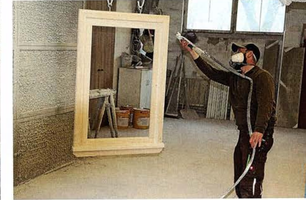
/ Schon beim Auftrag zeigt sich die Qualität eines Lacks. Da der neue Härter von Adler Isocyanat-frei ist, ist er in der Verarbeitung absolut unbedenklich.
